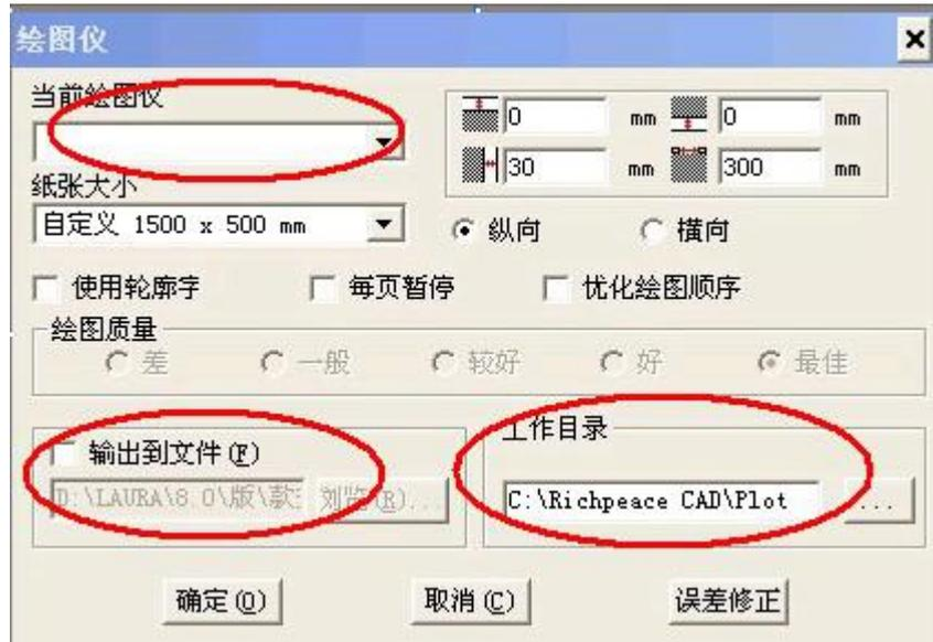
选择当前绘图仪的类型（注：您所用的机器型号），设置工作目录，然后点击“输出到文件”保存文件名，保存完后直接点击“确定”即可。
